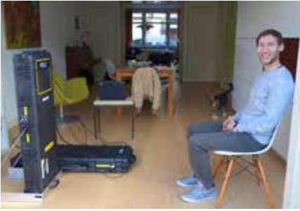
Figuur 2: De onderzoeksassistent toont hier de onderzoeksapparatuur voor radiofrequente (links) en extreem laag frequente (rechts) elektromagnetische signalen.
